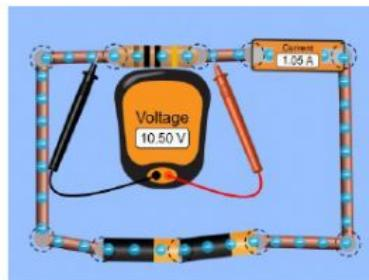
4. Tambahkan sebuah baterai kembali pada rangkaian (3 baterai disusun secara seri), kemudian catat kembali besar tegangan baterai yang tercatat pada voltage dan besar kuat arus listrik pada ammeter
