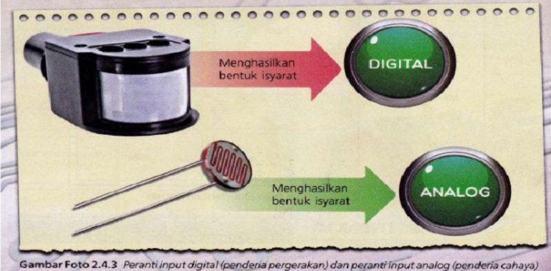
Gambar Foto 2.4.3 Peranti input digital (penderia pergerakan) dan peranti input analog (penderia cahaya)
