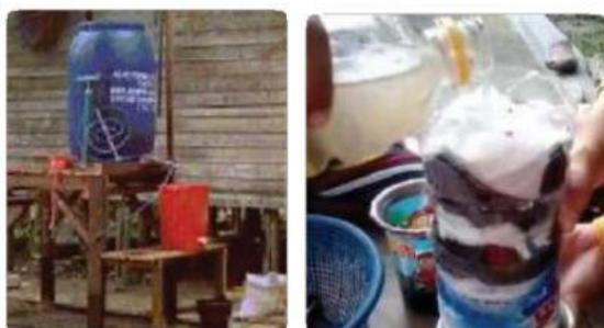
Ada berbagai macam cara sederhana yang dapat kita gunakan untuk mendapatkan air bersih. Cara yang paling mudah dan paling umum digunakan dengan membuat saringan air. Kita dapat membuat penjernih air atau saringan air sederhana. Perlu diperhatikan, bahwa air bersih yang dihasilkan dari proses penyaringan air secara sederhana tersebut tidak dapat menghilangkan sepenuhnya garam yang terlarut di dalam air.
