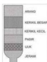
Ada beberapa macam cara sederhana untuk mendapatkan air bersih. Cara yang paling mudah adalah dengan teknik penyaringan dan teknik pengendapan. Pemilihan bahan penjernih air yang menggunakan cara penyaringan akan menentukan baik tidaknya hasil penjernihan air yang akan kita lakukan. Bahan penyaring adalah suatu material yang dapat menyerap berbagai kotoran, zat kimia, dan polutan lain yang ada di dalam air. Bahan penyaring dibedakan menjadi dua jenis, yaitu bahan alam dan bahan buatan
