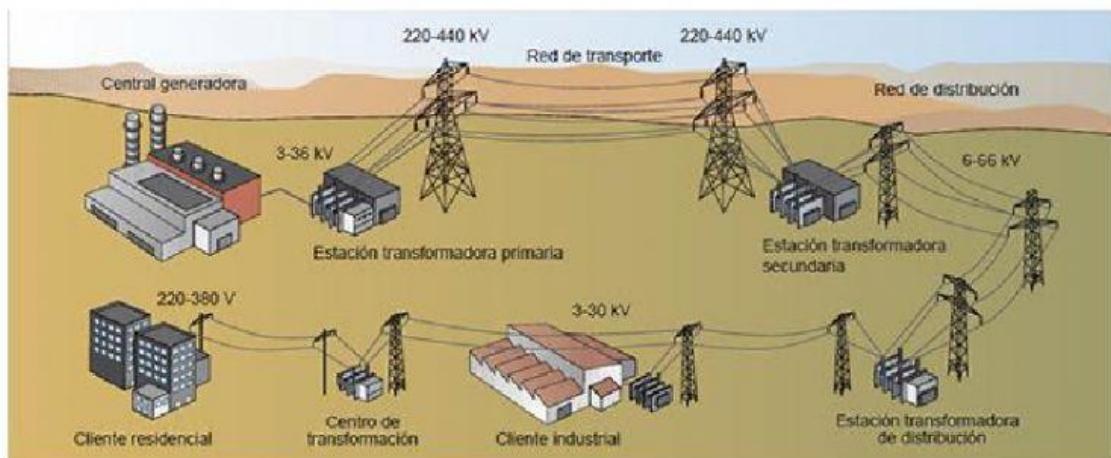
La energía eléctrica se genera en la  y se transporta a través de líneas de  hasta las ciudades. Pasa por distintas estaciones  que reducen el voltaje a  V. La red de  se conecta al edificio a través de la .
