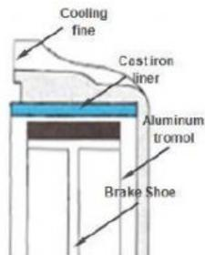
Gambar 1. 6 Penampang tromol dari aluminium
