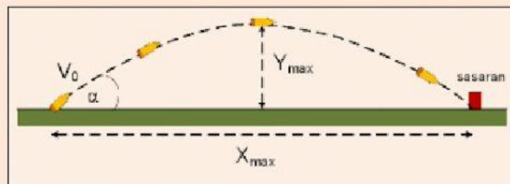
Berdasarkan gambar di atas, besar kecepatan awal bola adalah  $v_0$ , kecepatan pada sumbu x, yaitu  $v_x$  dengan arah dan besar selalu konstan atau sama seperti Gerak Lurus Beraturan (GLB), dan kecepatan pada sumbu y yaitu  $v_y$  dengan arah dan besarnya dipengaruhi oleh percepatan gravitasi seperti pada Gerak Lurus Berubah Beraturan (GLBB).
