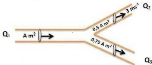
Fluida ideal mengalir pada pipa mendatar dengan luas penampang  $A \text{ m}^2$  kemudian fluida mengalir air pada dua pipa yang luas penampangnya lebih kecil seperti terlihat pada gambar. Perbandingkan kecepatan aliran fluida pada pipa yang luas penampangnya  $0,75 A \text{ m}^2$  dengan kecepatan aliran fluida pada pipa yang luas penampangnya  $0,5 A \text{ m}^2$  adalah....
