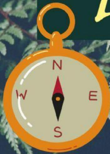
Instrumento para orientarse que consiste en una caja cuyo fondo representa la rosa de los vientos y en la cual hay una aguja imantada que gira libremente sobre un eje y que señala siempre el norte magnético.
