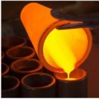
Fondre un metall perquè solidifiqui en un motllo
