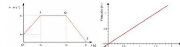
$$\text{se tiene: } x = \frac{v_f + v_0}{2} \cdot \frac{v_f - v_0}{a}$$
