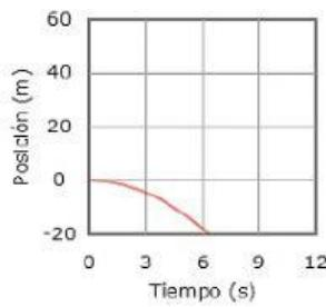
Puesto que el movimiento es rectilíneo uniformemente acelerado, la gráfica de la relación posición-tiempo siempre será una parábola, según que la aceleración sea positiva o negativa
