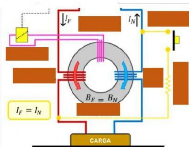
2) En el siguiente circuito identifique cada uno de los instrumentos, arrastrando la correspondiente magnitud medida según su conexión.
