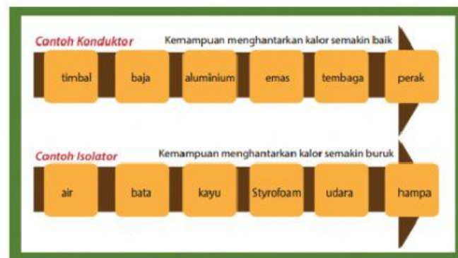
Gambar 4.29 Bahan-bahan konduktor dan isolator panas
