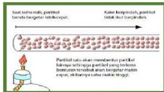
Gambar 4.28 Proses perpindahan kalor secara konduksi
