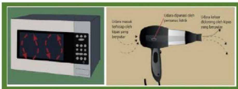
Gambar 4.34 Pemanfaatan perpindahan kalor secara konveksi pada bidang teknologi (oven dan hair dryer)
