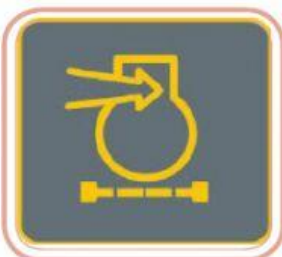
Figura 10: Marcador de restrição do filtro de ar
