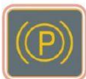
Figura 8: Marcador de alerta do freio de estacionamento
