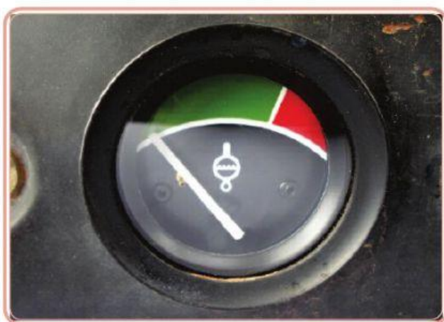
Figura 3: Marcador de temperatura da água do sistema de arrefecimento
