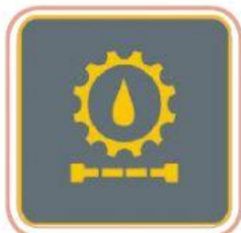
Figura 9: Marcador de alerta da pressão do óleo da caixa de câmbio
