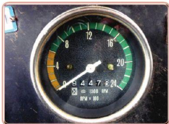
Figura 4: Modelo de tacómetro de um trator agrícola
