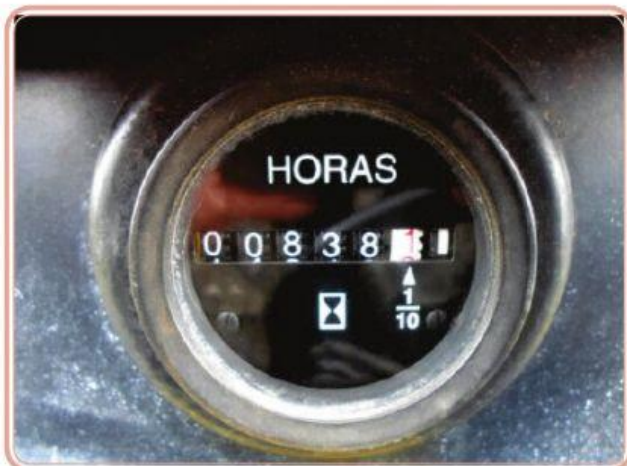
Figura 2: Modelo de horímetro utilizado em tratores agrícolas
