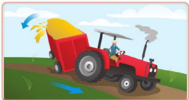
Figura 4: Em declives desça engrenado e não acione a embraiagem
