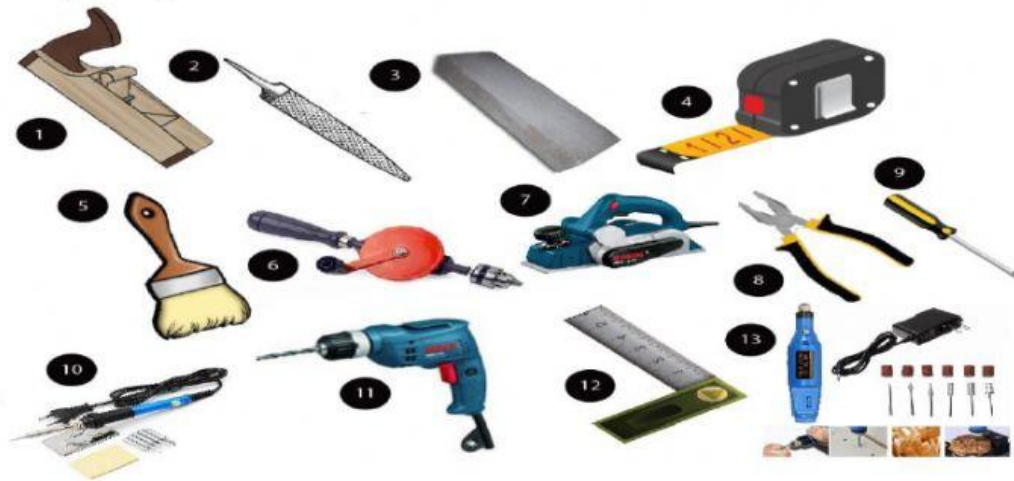
Gambar 1.3 Alat kerajinan kayu: 1. Ketam 2. Kikir, 3. Batu Asah, 4. Meteran, 5. Kuas, 6. Hand Drill/Bor Tangan, 7. Mesin Serut/Pasah, 8. Tang, 9. Obeng, 10. Solder Bakar, 11. Bor, 12. Penggaris Siku, 13. Mini Grinder
