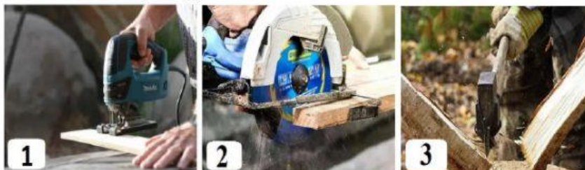
Gambar1.2. Alat potong: 1. Jigsaw, 2. Circle saw, 3. Kapak
