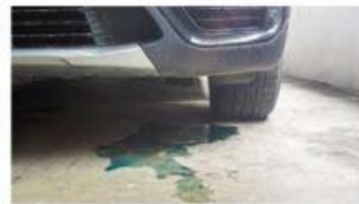
coolant leak - антифризов теч
