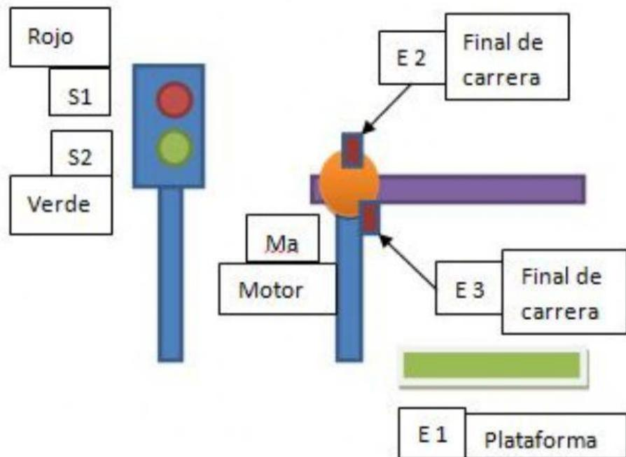
La barrera empieza con el semáforo en rojo. Cuando llega un coche y se sitúa encima de la plataforma el motor se tiene que poner en marcha y subir. Cuando llegue arriba se debe parar el motor y se apagará la luz roja y se encenderá la verde. Permanecerá arriba unos segundos y bajará, al mismo tiempo que el semáforo pasará a rojo y se apagará el verde. El motor se parará cuando llegue abajo. Se repetirá el ciclo indefinidamente.
