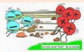
La **tensión o voltaje (V)** es el trabajo que hay que realizar para transportar una carga positiva entre dos puntos de un circuito. Su unidad, en el SI es el **Voltio (V)**.
