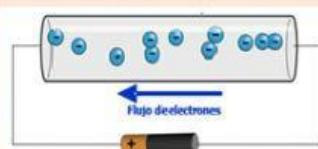
La **corriente eléctrica** se puede definir como el flujo de electrones a través de un material conductor desde un cuerpo con carga negativa (exceso de electrones) a un cuerpo con carga positiva (deficitario en electrones)
