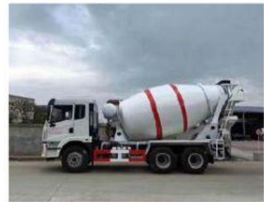
Camión revolvedora de concreto
