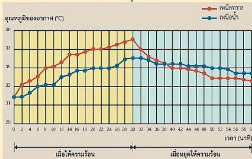
กราฟแสดงอุณหภูมิของอากาศเหนือทรายและเหนือน้ำทุก ๆ 2 นาที จนครบ 30 นาที เมื่อให้ความร้อนและหยุดให้ความร้อน
