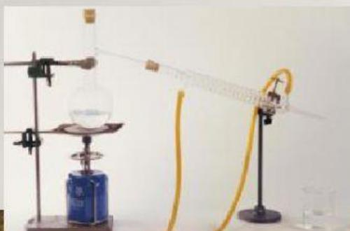
Se utiliza para separar líquidos disueltos y se basa en la diferencia de temperaturas de ebullición de que cada componente.
