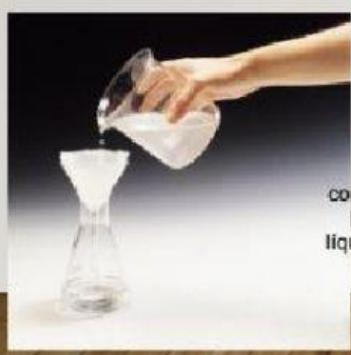
Permite分离 los componentes de una mezcla heterogénea de sólido y líquido haciéndolos atravesar un filtro.
