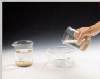
La gravedad separa los componentes de una mezcla con distinta densidad.
