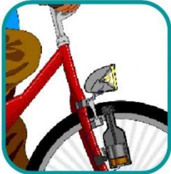
Lampu pada sepeda terhubung dengan sebuah dinamo yang tersusun atas kumparan dan magnet.
