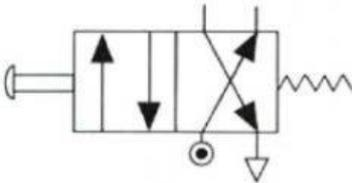
Válvula 5/2 con accionamiento por pedal y retorno por resorte.
