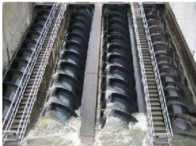
El **tornillo de Arquímedes**, que ya se utilizaba en la antigua Grecia, es una máquina simple que sirve para elevar cargas o fluidos, como el agua de un estanque hasta el nivel de un canal de riego.
