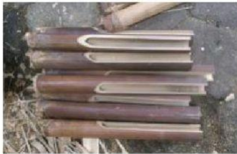
Gambar 3.13 Bambu untuk tabung suara
