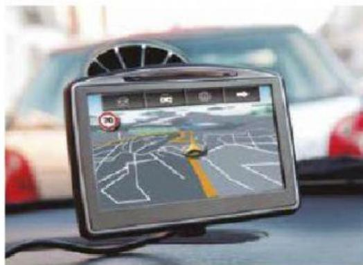
◆ Un receptor de GPS determina las coordenadas geográficas de cualquier lugar de la superficie terrestre, incluso localiza objetos fijos o en movimiento.
