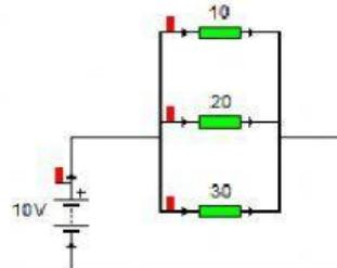
2.-Calcula la intensidad total, la intensidad por cada resistencia, la Resistencia total y la caída de tensión en cada resistencia. ( $V_{pila}=10(V)$  )
