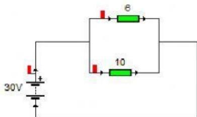
4.-Calcula la intensidad total, la intensidad por cada resistencia, la Resistencia total y la caída de tensión en cada resistencia. ( $V_{pila}=30V$  )
