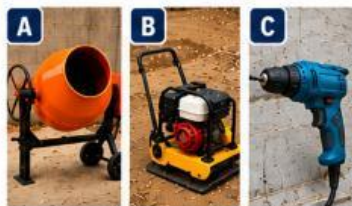
A Formigonera B Compactadora C Trepant
