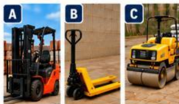
A Toro elevador B Transpalet C Compactadora
