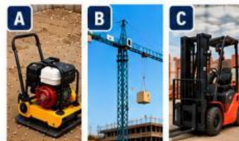
A Compactadora B Grúa torre C Toro elevador
