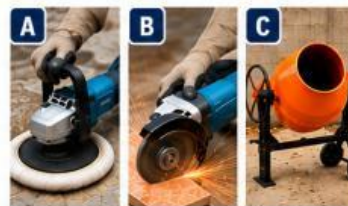
A Polidora B Radial-amoladora C Formigonera
