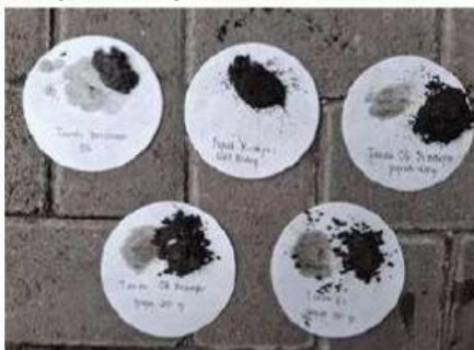
Gambar 5. Pengujian kadar minyak pada tanah menggunakan kertas buram
