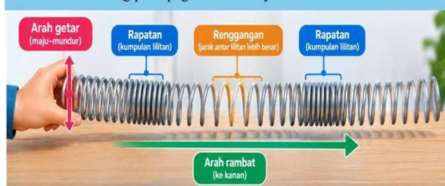
Gambar 4. Pegas atau slinky yang menunjukkan rapatan, renggangan, arah getar, dan arah rambat
