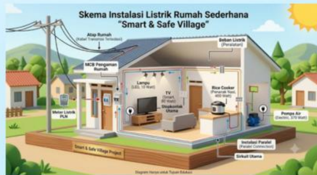
Gambar 3. instalasi listrik rumah sederhana yang menunjukkan MCB di depan rumah, kabel transmisi di atas atap, dan beberapa beban (lampu, TV, pompa air) yang disusun paralel di dalam rumah. Berikan label spesifikasi daya (Watt) pada tiap alat (2026)
