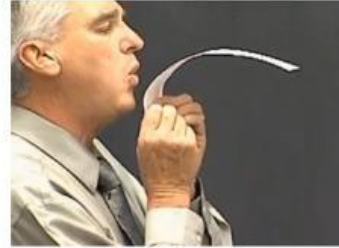
Gambar 1. Ilustrasi percobaan aliran udara pada bagian atas kertas
