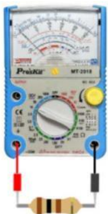
รูปที่ 6.1 การวัดตัวต้านทานโดยใช้แอนะลอกมัลติมิเตอร์และดิจิทัมัลติมิเตอร์
