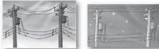
Gambar 5.1 pemuaian panjang pada kabel
