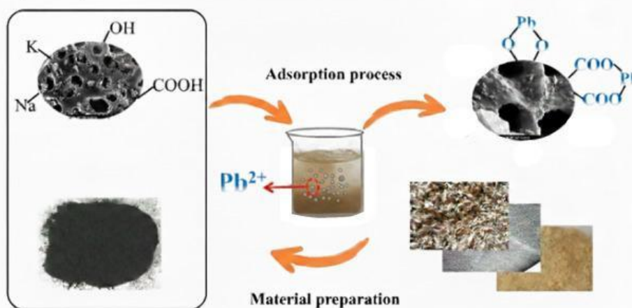
Gambar 6. Mekanisme Adsorpsi Logam Berat oleh Bioadsorben (Sumber: Science of The Total Environment )
