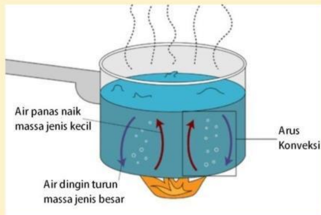
Gambar 1. Mekanisme Pergerakan Partikel dalam Konveksi/ Arus Konveksi
