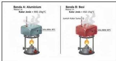
Dua benda memiliki massa yang sama dan dipanaskan dengan jumlah kalor yang sama dan waktu yang sama. Benda A terbuat dari aluminium dengan kalor jenis  $900 \text{ J/kg}^{\circ}\text{C}$ , sedangkan benda B terbuat dari besi dengan kalor jenis  $450 \text{ J/kg}^{\circ}\text{C}$ . Benda manakah yang mengalami kenaikan suhu lebih tinggi?
