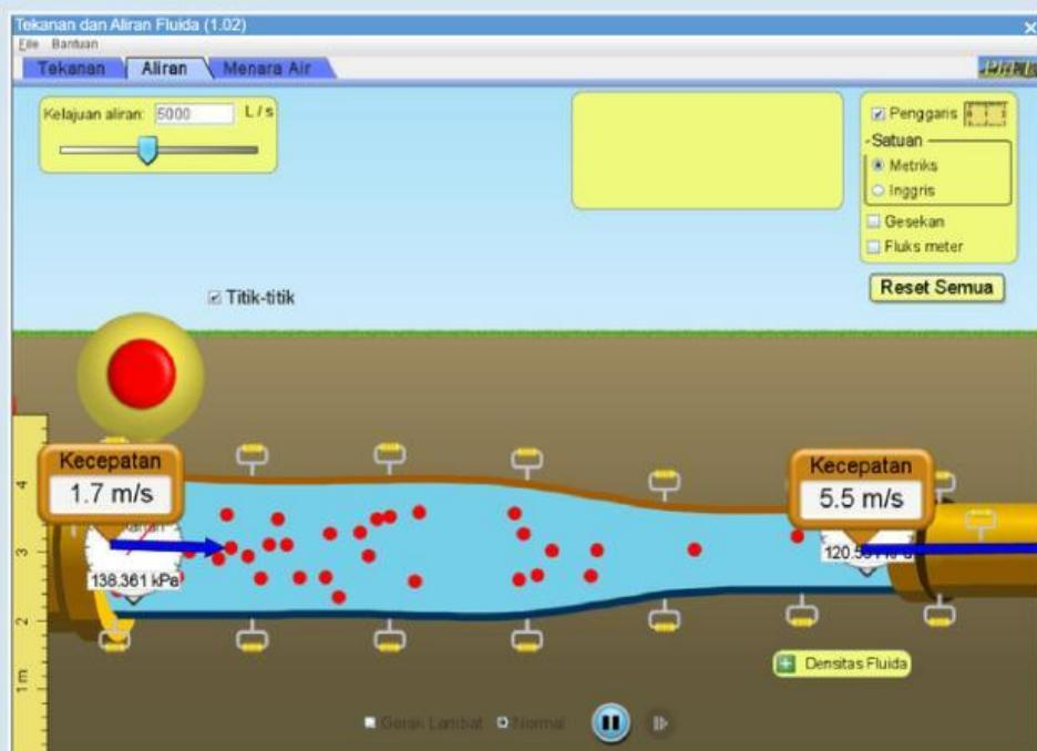
9.Untuk mencari data kedua dan ketiga, ubah pipa 2 dengan bagian tengah pipa tepat pada ketinggian pada ketinggian 4 cm dan 5 cm (nilai 5 cm terletak pada ujung mistar, jadi usahakan ujung mistar terletak pada tengah pipa), kemudian catat hasil tekanan dan kecepatannya.
