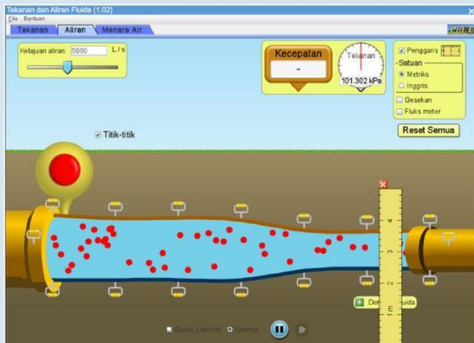
8. Setelah itu pilih fitur "Tekanan" dan "Kecepatan" kemudian letakkan keduanya pada pipa 1 dan pipa 2. Catat hasil dari tekanan dan kecepatan yang dihasilkan dari masing-masing pipa.
