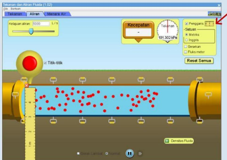
6. Untuk mengambil data yang pertama, ubah pipa bagian kiri sebagai pipa 1 (ukuran besar) dengan bagian tengah pipa tepat pada ketinggian 3 cm.
