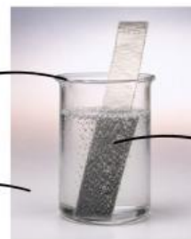
Gambar 5c. Pita Mg dengan HCl (Brady, 2012)
