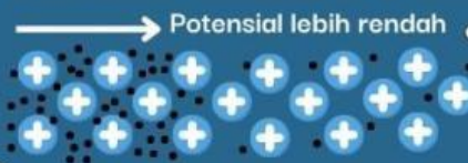
Gambar 12. Elektron membawa muatan listrik menuju potensial rendah, sehingga terjadi aliran listrik
