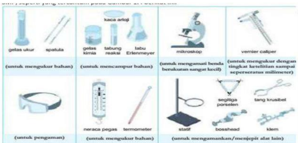
Gambar 1.4 Beberapa alat laboratorium IPA yang sering digunakan dalam percobaan. Sumber: Purnomo Heinemann/Windy Gurita (2009)
