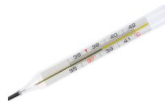
Gambar 8. Termometer air raksa Sumber: Canva.com
