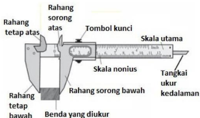
Gambar 4.4 Bagian-Bagian Jangka Sorong
