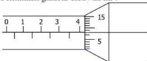
Gambar menunjukkan pengukuran suatu benda menggunakan mikrometer sekrup. Hasil pengukuran tersebut dapat dinyatakan sebagai berikut ...
