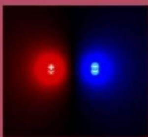
Potensi elektrostatik dapat ditampilkan menggunakan kotak centang "Voltage". Semakin cerah wernanya, semakin besar tegangannya. Tegangan positif berwarna merah, dan tegangan negatif berwarna biru, hitam mewakili 0 V (meskipun tegangan yang relatif kecil juga bisa tampak hitam).
