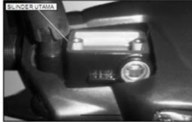
gambar 15 pelepasan silinder utama
