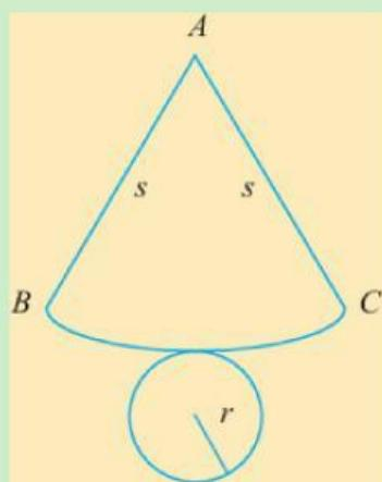
Luas permukaan ekuivalen dengan jumlahan semua luas bangun penyusun dari jaring-jaring kerucut. Jaring-jaring kerucut terdiri atas satu lingkaran dan satu selimut yang berbentuk juring.
