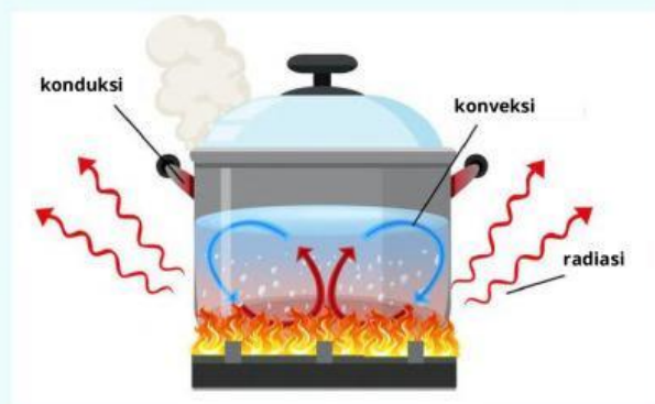
Gambar 7. Metode transfer panas konveksi
