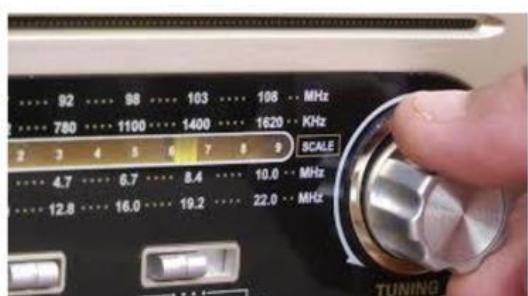
Tuning adalah bagian dari radio yang bisa digunakan untuk memilih frekuensi, contohnya dari 86,5 FM ke 105,7 FM. Tuning pada radio adalah proses memilih atau "menyetel" stasiun radio tertentu untuk didengarkan, yang dilakukan dengan menyesuaikan frekuensi resonansi dari rangkaian di dalam radio agar
