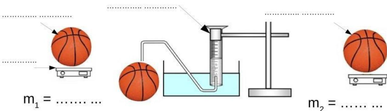
2. Calculer la masse d'un litre d'air à l'aide des résultats de l'expérience ci-dessus.
